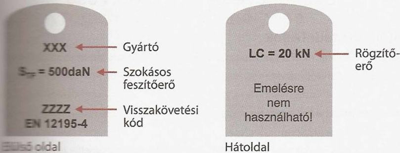
44. ábra: A drótkötél jelölécímkéje
